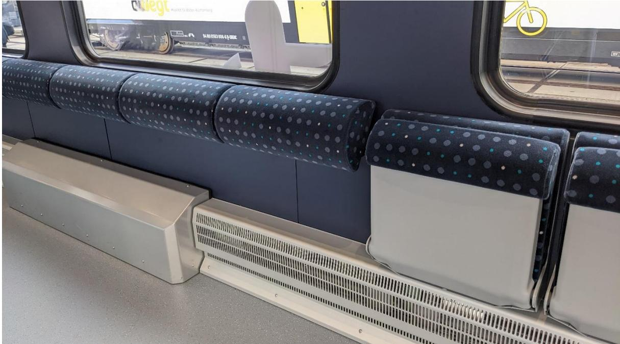
Abbildung 2: beispielhafte Darstellung einer Stehhilfe und Klappsitz mit integrierter Stehhilfe; Quelle: TLBV
